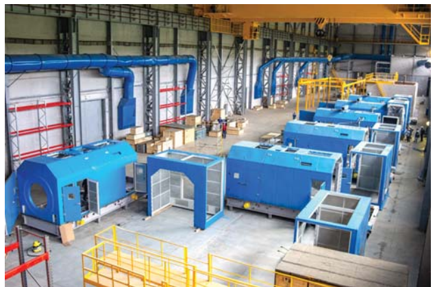
Фото 3. Новый производственный цех по производству ГПА блочно-модульной конструкции. Изготовление силовых блоков ГПА-25 МВт
